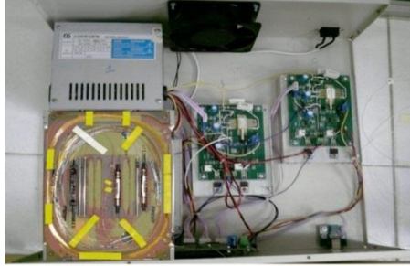
Hình 2.7: Cấu hình RFA hoàn chỉnh được ghép từ phần quang tử và phần điện tử
