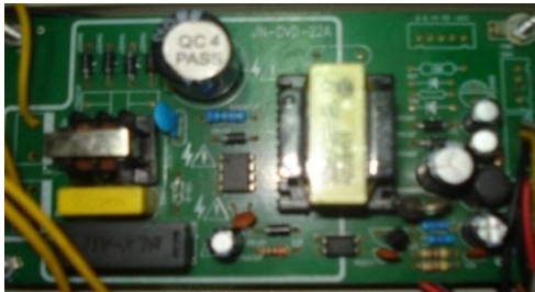
Hình 2.4: Mạch điện cấp dòng nuôi ổn định cho các mô-đun laser bơm
